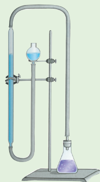
图2-3-4 量气法测定化学反应速率
