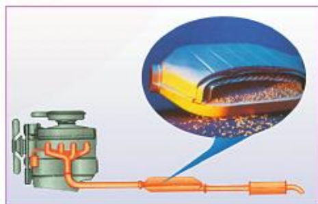
图 2-9 催化剂用于汽车尾气的净化
