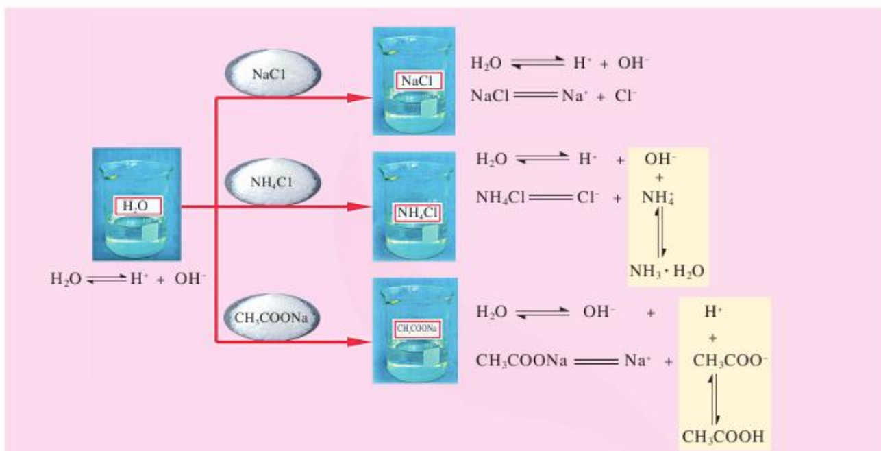
图 3-17 三种不同类型的盐溶于水后的变化
