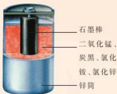
图 1-12 普通锌锰干电池的构造示意图
