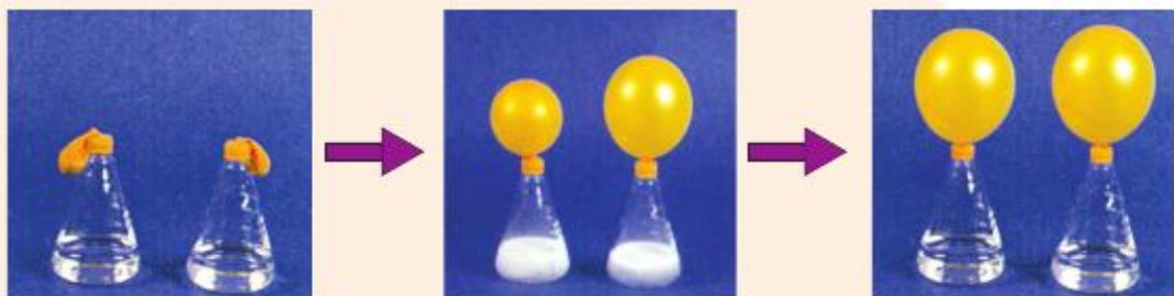
图 3-1 镁条与醋酸、盐酸的反应
