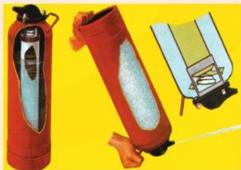
图 3-18 泡沫灭火器的原理和构造
