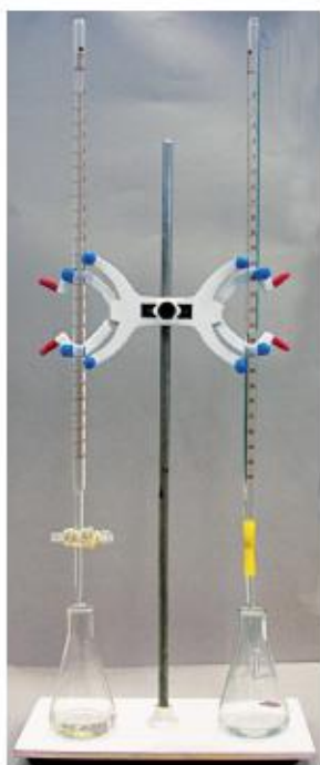
图 3-13 酸式、碱式滴定管
