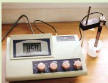
图 3-12 用 pH 计测量溶液的 pH
