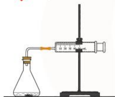
图 2-3 大理石与盐酸反应的实验装置图
